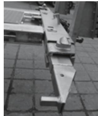
Боковые пружинные защелки на полуприцепе открыть. Вытянуть салазки на приблизительно 5 см вперед. Отпустить пружинные защелки и салазки вытянуть до второй позиции фиксации. Пружинные защелки должны самостоятельно защелкнуться. Освободить болты поворотной кулисы и кулису задвинуть во внутреннюю позицию загрузки.
