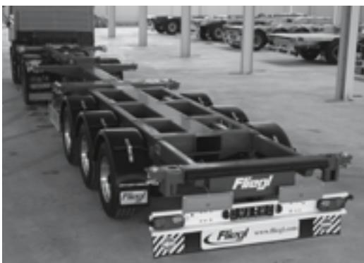
Шасси Варио имеет две выдвижные части. Задняя
