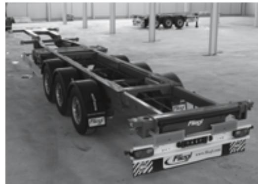
Операции на данных шасси отличаются от обычных Штэрр в основном из-за регулировки задней выдвижной части.
