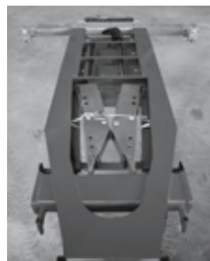
→ Салазки разфиксировать при помощи откручивания Т-болтов с боковой стороны рамы и выдвинуть вперед. На уровне маркировки болты вставить назад и зафиксировать.
