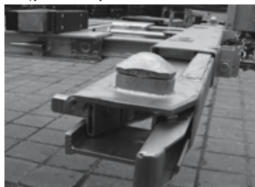
Салазки находятся в позиции спокойствия на шасси. Толкающая кулиса поворотной цапфы за счет выемки маленького болта разблокированна. Вытянуть поворотные цапфы. Болты вставить в наружные отверстия несущей руки и зафиксировать (вне длинного центрирования). Поворотные цапфы за счет вытягивания ручки поставить в позицию погрузка.
