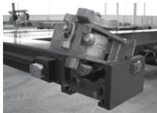
Замок цапфы при помощи рычага будет освобожден изнутри и вдвинут во второе положение. Ручной рычаг должен зафиксироваться.
