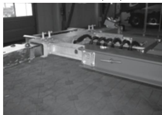
→ Несущую руку снять из положения складирования на полуприцепе.
