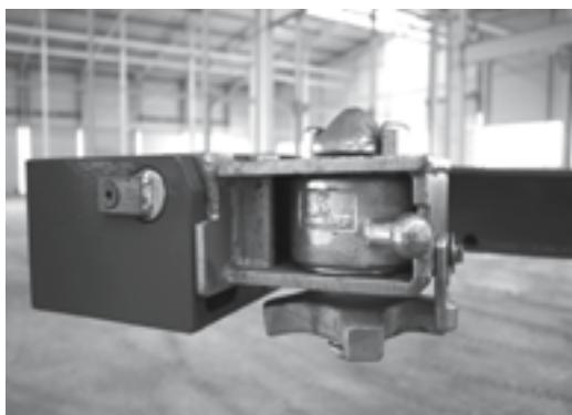
Для стандартной фиксации выносной плиты с поворотными цапфами в несущую позицию повернуть, поворотные цапфы повернуть в позицию загрузки. Затем сдвинуть замки цапф на первую позицию. Для этого ручной рычаг придавить к наружной стороне ручки (освобожденная позиция) и толкать до первого места фиксации.
