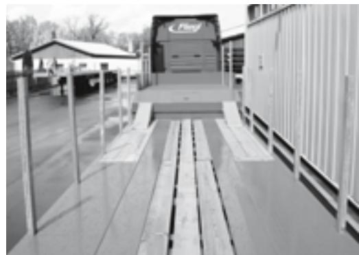
Погрузочные поверхности низкорамных лафетов как обычно не защищены от погодных условий, пыли и грязи. Обратите внимание на то чтобы все расчеты по надежного креплению груза соответствовали состоянию техники и чтобы загрузочные поверхности были чистыми и сухими.
