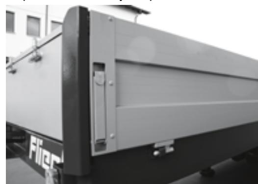
⚠ Езда с откинутыми бортами на шарнирах запрещено. Снимите данные борта (поставте их в горизонтальное положение и вытяните их в сторону) и закрепите их надежно на загрузочной площадке.
