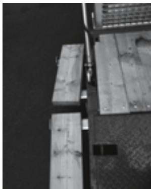
⚠ Элементы дополнительного днища не имеют самостоятельного страховочного крепления! Вы должны обеспечить чтобы элементы дополнительного днища были прижаты грузом к несущим траверзам, в противном случае (если они использовались только при погрузке) их необходимо снять и закрепить стяжными ремнями, цепями и т.д.
