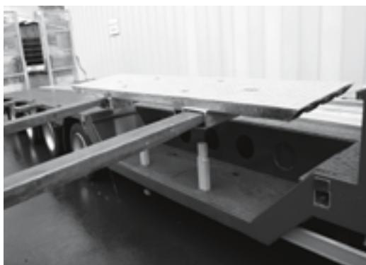
Дополнительное днище служит для расширения загрузочной площади. Он укладывается как на поворотные так и на телескопические траверзы. Поверните траверзу или нажмите на защелку и выдвините телескопическую траверзу наружу. Обратите внимание на то, чтобы все траверзы были выдвинуты для того чтобы Вы смогли установить элементы дополнительного днища.
