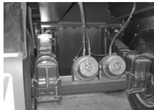
Пневмоподвеска на низкорамном лафете подобная как и на стандартном трейлере. Руководство по её эксплуатации описано в А-ВА стр.11 и 17. В зависимости от характера груза (например проезд под мостом) или же при погрузке-разгрузке пневмосистему можно поднять или опустить, однако передвигаться в таком состоянии можно только медленным темпом и не больше 500 метров. При передвижение ручка должна находиться в положение движения (ручка в позиции по середине или выдвинута (ХАЛДЕКС).
